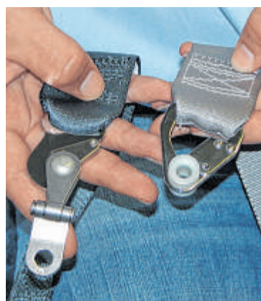
Eine leichte Kunststoffbuchse (rechts) ersetzt die lange schwere Metallbefestigung (links im Bild). FOTO: SCHWARZ
